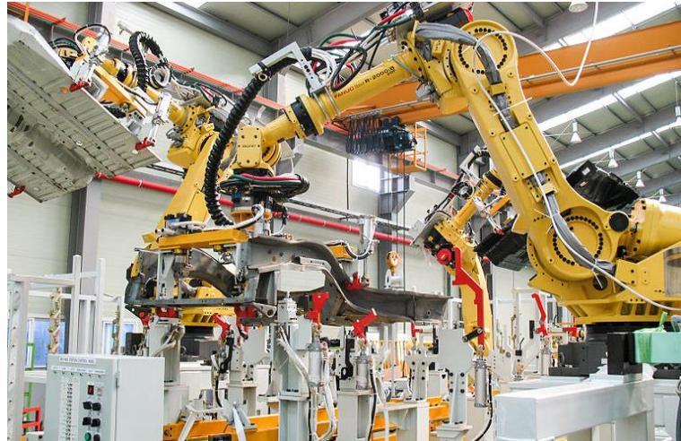
Ein Roboter setzt in einem Automobilwerk das Dach auf die vorgefertigten Autos. Dazu muss er so programmiert werden, dass die Teile an der richtigen Stelle landen.
